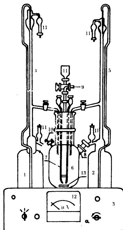
图 1 微量水分测定仪示意图
